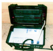
CENTRALINA DI ALIMENTAZIONE SORGENTE DI RUMORE ROSA SVANTEK - SI 513 500 W VOLUME MAX OLTRE 120 dB(A) DOTATA DI TELECOMANDO ( 1 telecomando funziona anche tra piani diversi )
