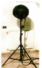
CENTRALINA DI ALIMENTAZIONE SORGENTE DI RUMORE ROSA SVANTEK - SI 513 500 W VOLUME MAX OLTRE 120 dB(A) DOTATA DI TELECOMANDO ( 1 telecomando funziona anche tra piani diversi )
